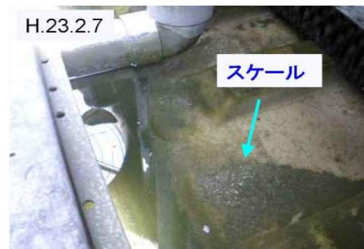
H.23.2.7テスト終了時タワー内にはタワー及び機器等から溶解流出したスケールが凝集沈殿しているのが確認できた。
